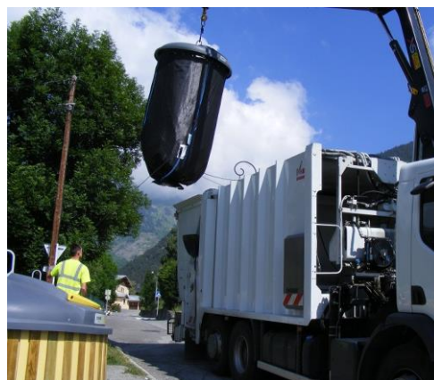
Collecte par camion-grue
