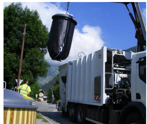
Collecte par camion-grue
