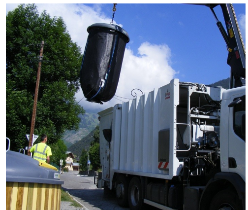
Collecte par camion-grue
